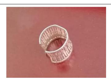
主要是插接接触问题,里面接触簧圈在使用过程中弹性减小,接触电阻增大。一个是簧圈材料(铍青铜)问题,需要寻找合适的材料或者铍铜弹性疲劳改进的工艺方案,再就是结构优化使得接触电阻增大减缓。
